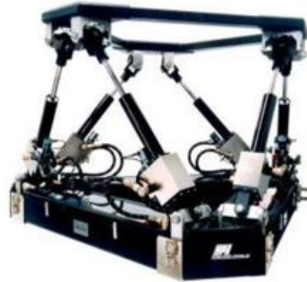
Robot paralelo. Cortesía de Hydra-Power Systems
