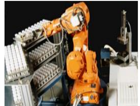
Buffer para almacenamiento de envases en sistema robotizado de muestreo
