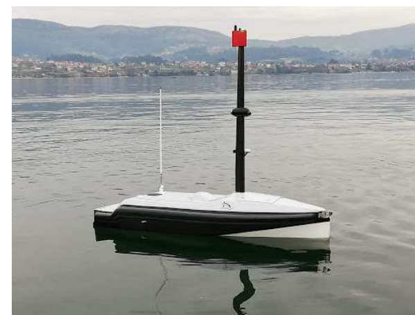
USV MIST para Marine Instruments 3.50 m de eslora/45 nudos
