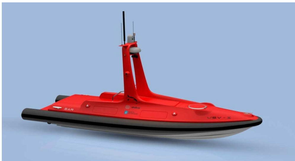
USV-1 Multipropósito Indra Seadrone. 7.10 m de eslora, 38 Nudos
