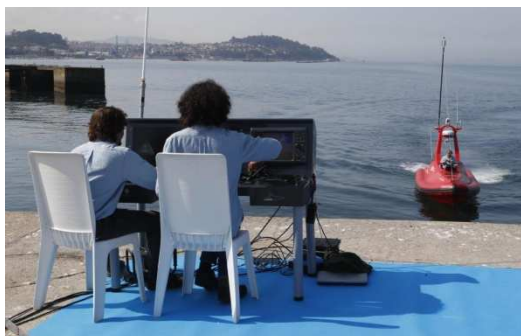
Pez prototipo de sonar de barrido lateral para Marine Instruments
