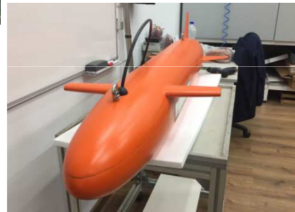
Pez prototipo de sonar de barrido lateral para Marine Instruments
