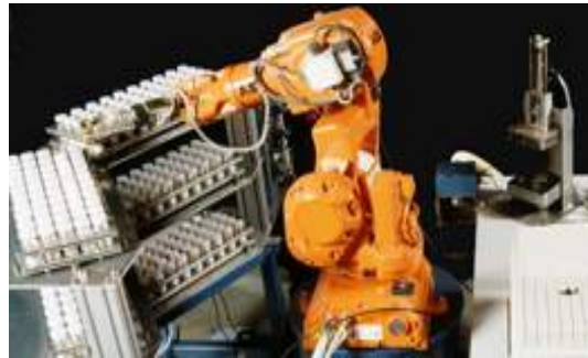
Buffer para almacenamiento de envases en sistema robotizado de muestreo
