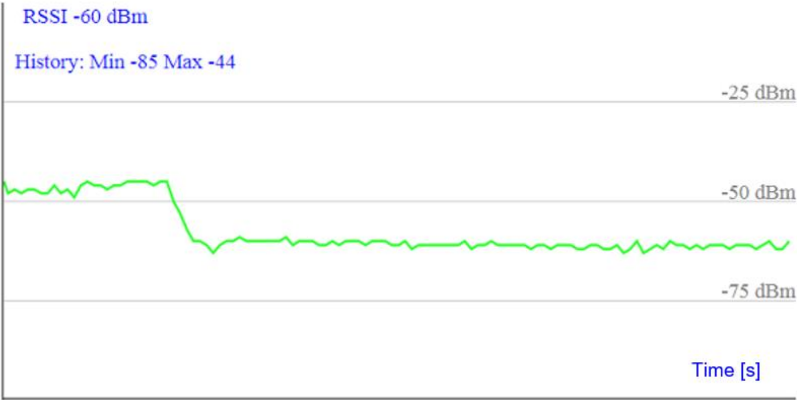
Variación del RSSI con la rotación de la antena 90°.
